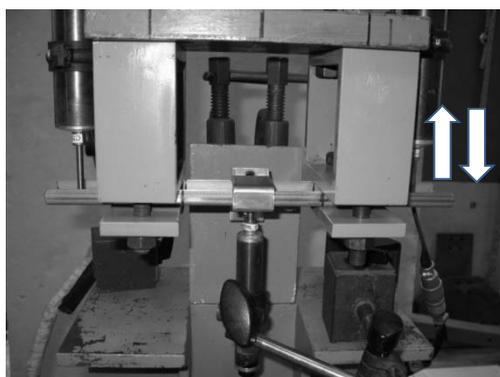
図 3.3.3 ハンガーを含む接合部の試験体の取り付け状況の例
