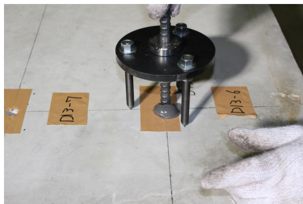
解図 2.1.2 アンカー打設用治具の例
