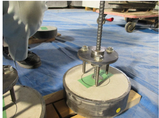
解図 2.1.7 アンカー施工用治具の例
