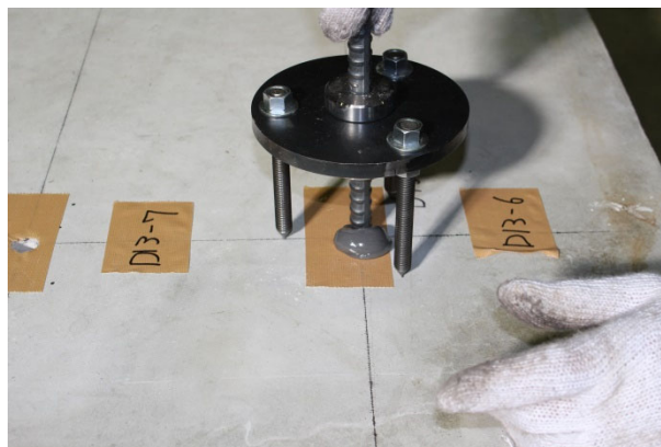
解図 2.2.2 アンカー打設用治具の例
