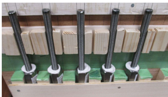
解図 2.4.1 接着試験体製作用治具の例
