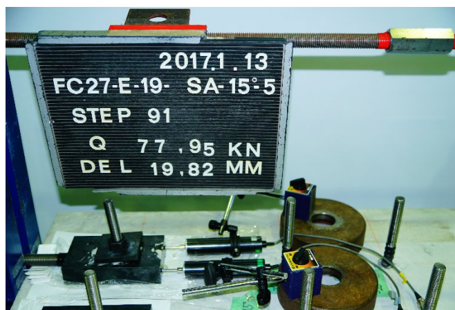
解図 2.2.6 変位測定装置の例
