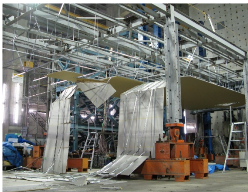
(a) JIS クリップの外れによる大規模な落下
