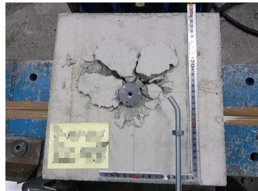
写真-4 破壊状況(引張0×せん断1) (母材コンクリートの支圧破壊)
