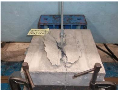
写真-3 破壊状況(引張1×せん断0) (母材コンクリートのコーン状破壊)
